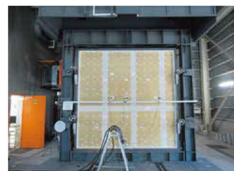
非耐力壁の試験状況
