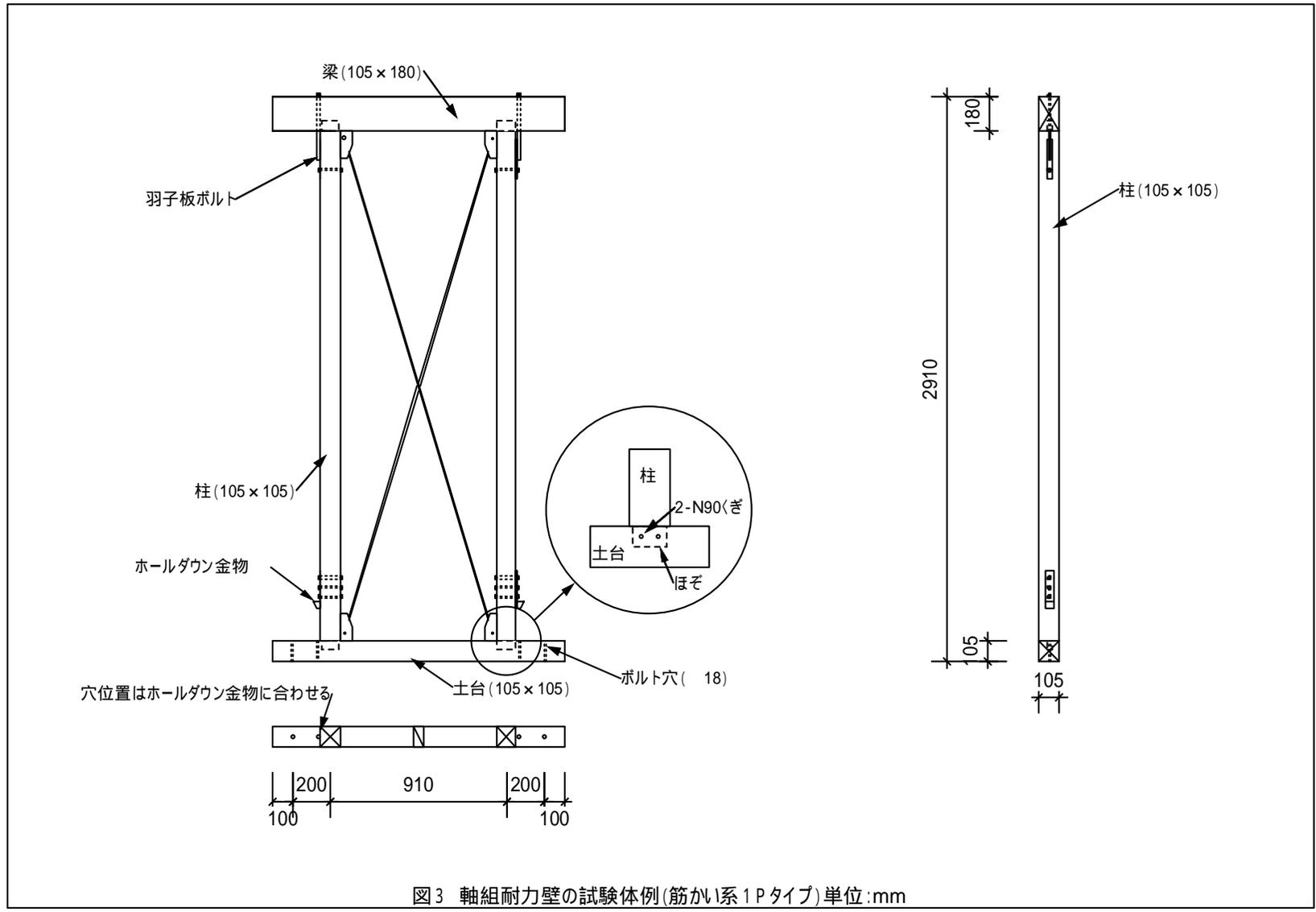
図3 軸組耐力壁の試験体例(筋かい系1Pタイプ)単位:mm
