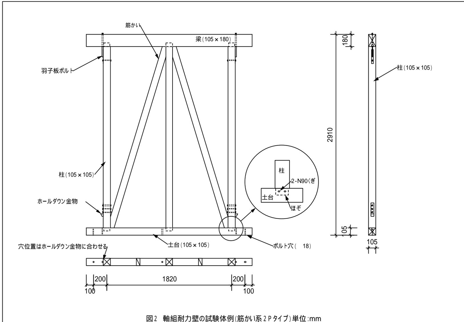
図2 軸組耐力壁の試験体例(筋かい系2Pタイプ)単位:mm
