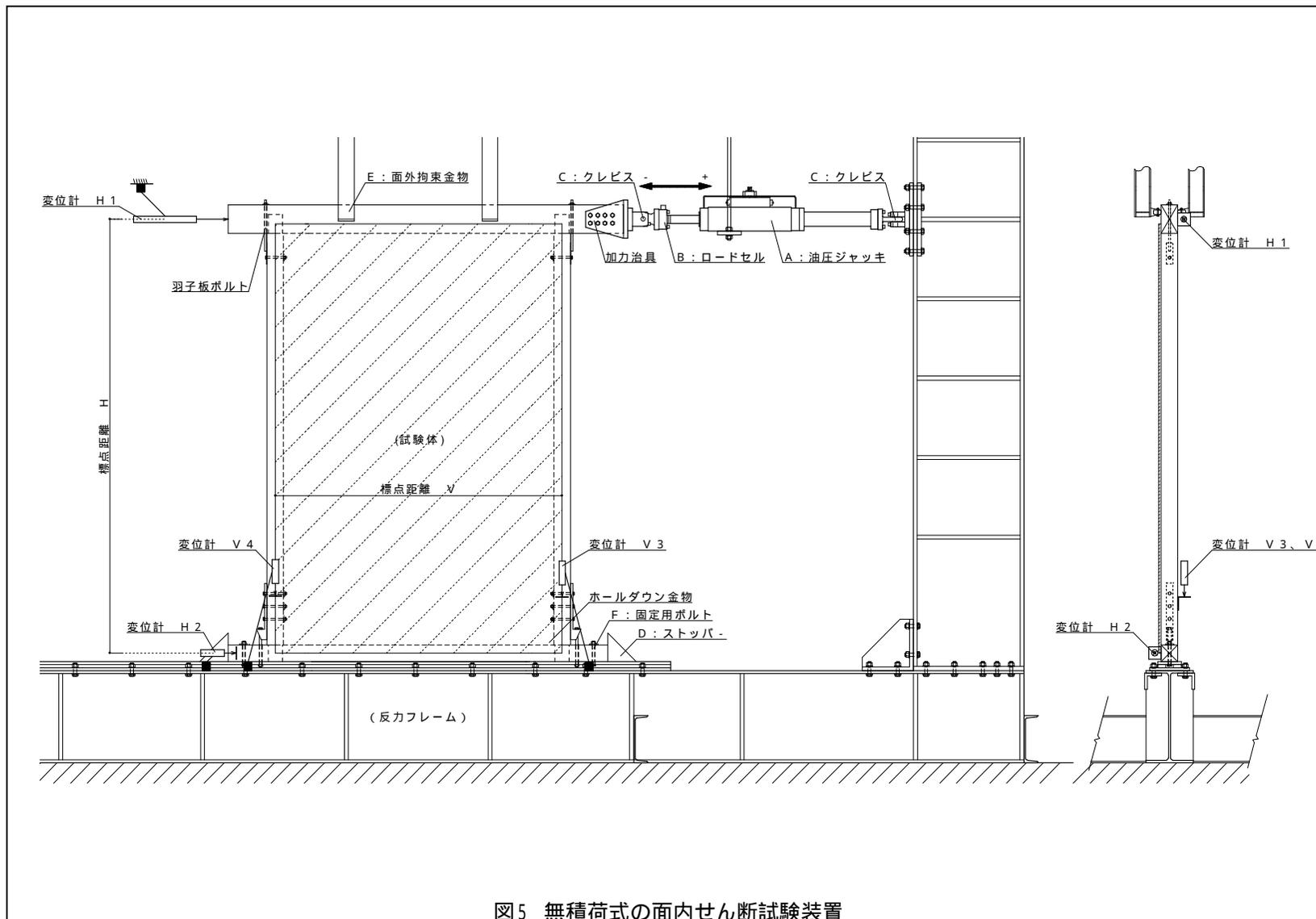
図5 無積荷式の面内せん断試験装置
